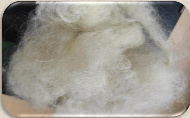
Slika 7. (a) Lička vuna Pasmina ovce za meso koja u grubljoj klimi daje i grublju vunu. Vuna je čvrsta i otporna, a uglavnom se baca.
